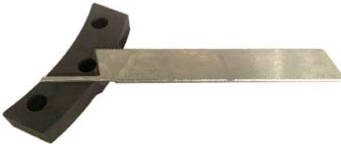
Рис. 1. Нож верхний гипсомешалки с наплавленным твердосплавным слоем
