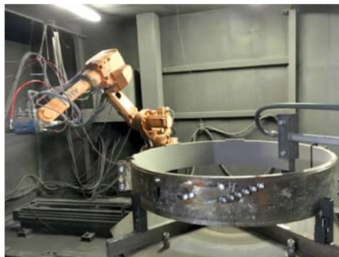
Рис. 4. Высокоскоростное напыление износостойкого покрытия на корпусные детали оборудования линии производства гипсокартона
